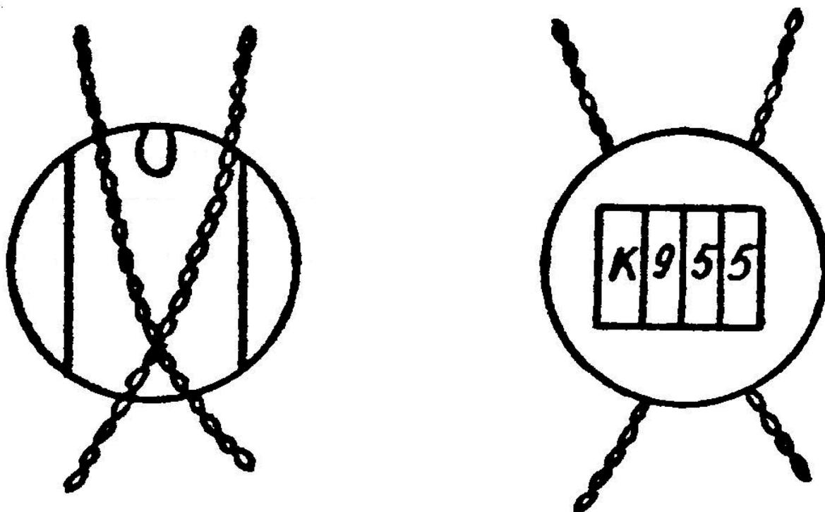
При навешивании свинцовой пломбы с камерой концы проволоки должны быть пропущены через входные отверстия пломбы, скручены в два - три витка, втянуты в камеру пломбы и зажаты тисками.
