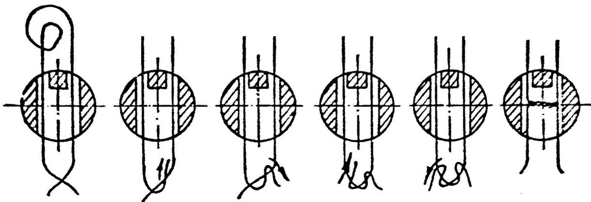
При навешивании полиэтиленовой пломбы с камерой концы проволоки должны быть пропущены через входные отверстия пломбы в приведенном на рисунке порядке.
