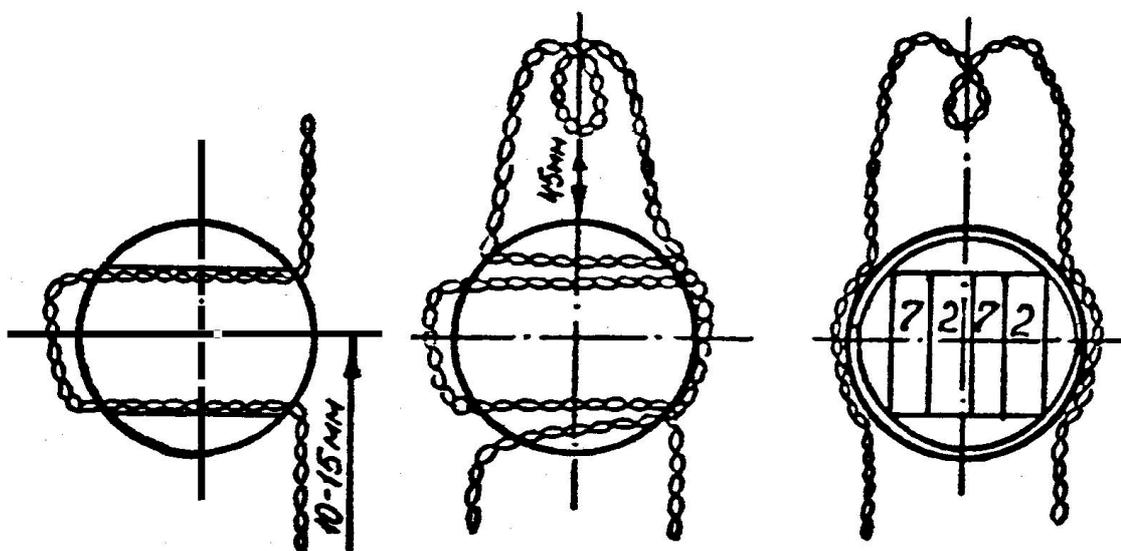
При навешивании свинцовой пломбы с двумя параллельными отверстиями в каждое из отверстий должен быть продет один конец проволоки. Свободный конец проволоки должен быть пропущен два раза сквозь ушко дверной накладки двери фургона (контейнера), а затем продет через два отверстия пломбы. После этого пломба должна быть зажата тисками.
